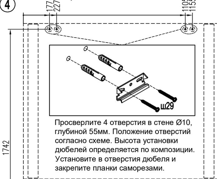
Просверлите 4 отверстия в стене  $\varnothing 10$ , глубиной 55мм. Положение отверстий согласно схеме. Высота установки дюбелей определяется по композиции. Установите в отверстия дюбеля и закрепите планки саморезами.
