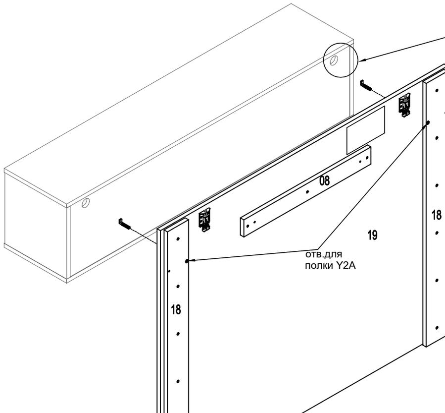
Досверлить 2 отверстия диаметром 5. Чтобы отверстия получились аккуратными, на выходе сверла прижать брусок. С лицевой стороны вкрутить крючки резьбовые 5x35 (из упаковки полки).
